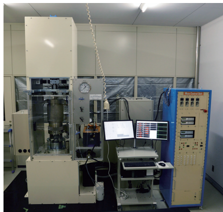
図 海洋研究開発機構・高知コア研究所に設置されている回転式熱水剪断試験機。すべり速度10 nm/s~1 m/s、垂直荷重150kN、水圧120 MPa、温度500°Cのスペックを有し、円筒形もしくは粉末試料を圧力下でねじり剪断させることによって多様な地震断層すべりを熱水環境下で再現することができる。
