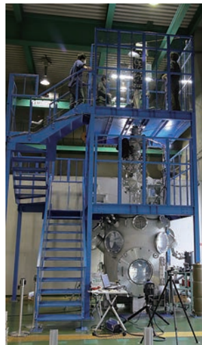
図 JAXA/ISASに設置された垂直式二段式軽ガス銃。直径数mmの弾丸を最高秒速7kmで標的に打ち込むことができる。地球初期の天体衝突速度は20-30km/sであったと推測されている。
